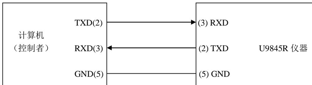
图 5-1-1 仪器与计算机连接简图
