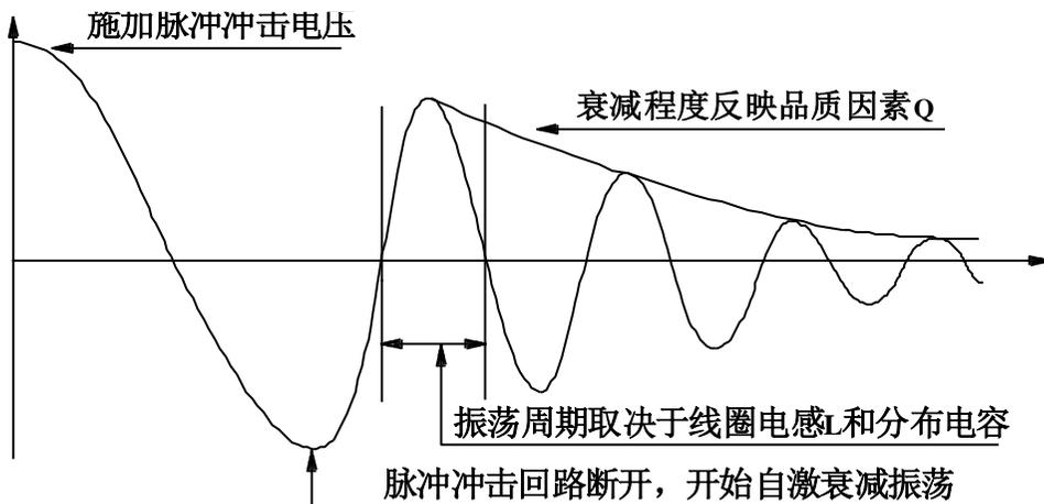
图 1-2 典型的线圈自激衰减振荡波形
