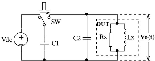
图 1-1 线圈层间短路测试原理简图
