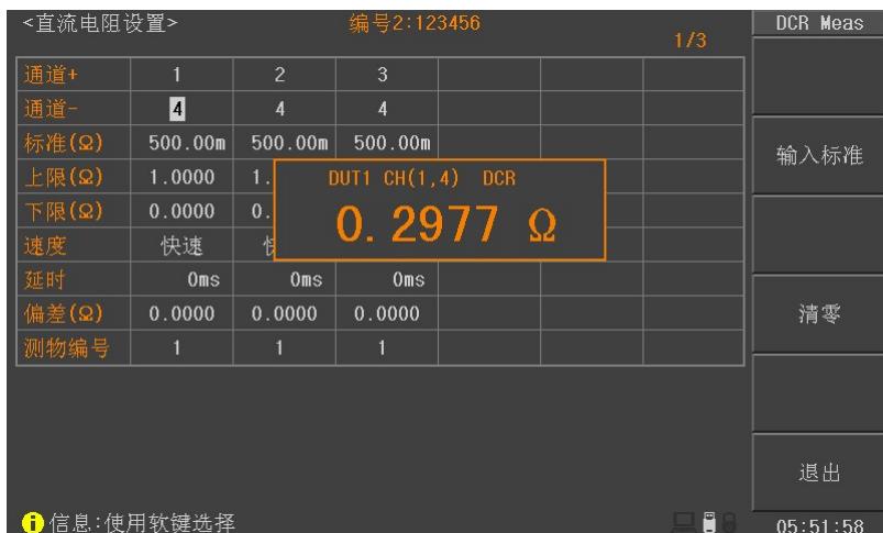
图 4-1-5-3 直流电阻测试
