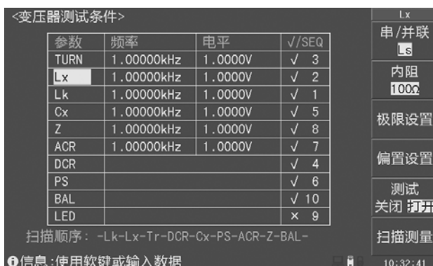
图 4-18 Lx（电感量）测试条件设置
