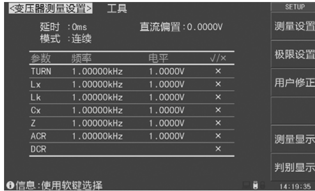
图 3-5 变压器测量设置
